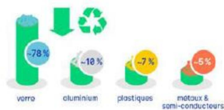
Figure 11 : Composition d'un panneaux photovoltaïque monocristallin
